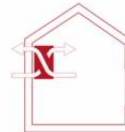
Ventilação com RC
