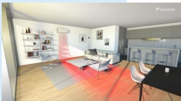
Em **aquecimento** os flaps são orientados para baixo para que o ar quente seja insuflado junto à parede. O ar quente é mais leve e sobe suavemente de forma a climatizar o espaço de forma mais homogénea e eficiente.
