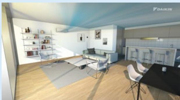
Em **arrefecimento** os flaps são orientados para cima para que o ar frio seja insuflado junto ao teto. O ar frio é mais pesado e desce suavemente de forma a climatizar o espaço de forma mais homogénea e eficiente.
